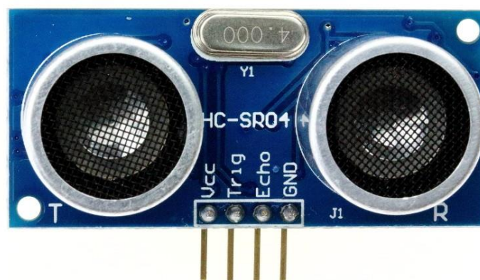
10. ábra: A HC-SR04 ultrahangos szenzor
