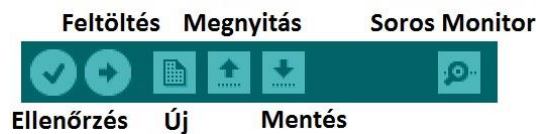
5. ábra: Az Arduino IDE eszközsora
