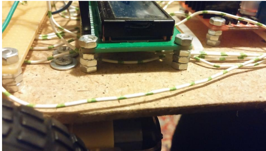
38. ábra: Az anyacsavarokkal megemelt elektronikai elemek
