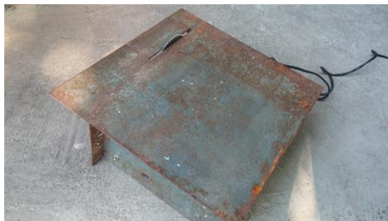
34. ábra: A vágásoknál felhasznált házi készítésű kis cirkula
