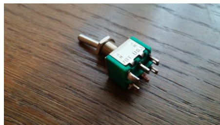
41. ábra: A felhasznált háromállású kapcsolóm, melyet kétállásúra alakítottam
