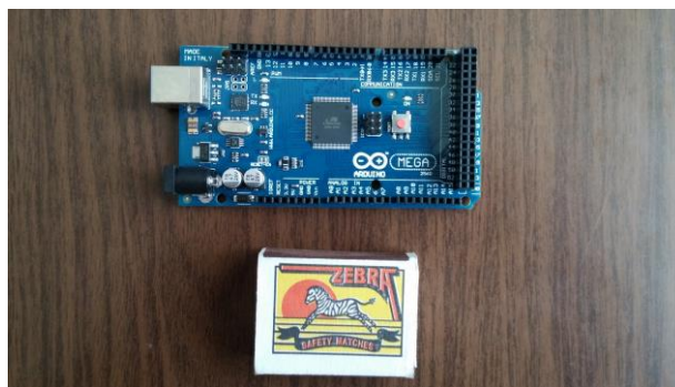
7. ábra: Arduino Mega 2560 mérete egy gyufásdoboz mellett
