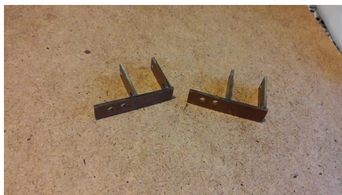
36. ábra: Az elkészült motortartók
