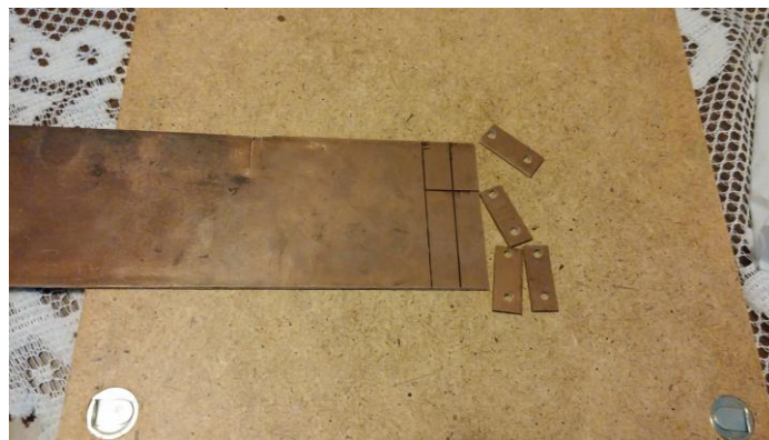
35. ábra: A készülő motortartók
