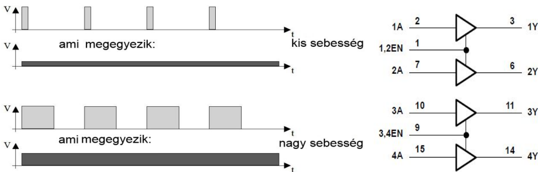
44. ábra: PWM különböző kitöltési tényezőkre (bal oldalt) [1], és Az L293B logikai felépítése (jobb oldalt)[16]
