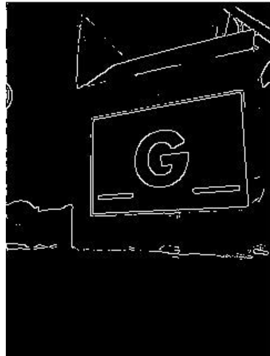
27. ábra: Az eredeti kép (bal oldalt), és a Canny élfelismerő módszer után (jobb oldal)
