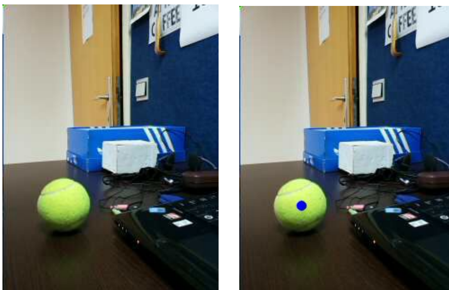
34. ábra: az eredeti kép (bal oldal) a hisztogramokkal meghatározott pont (jobb oldal)
