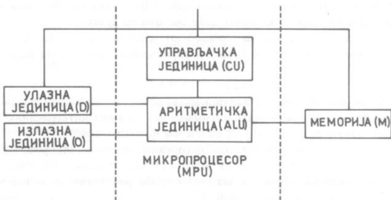
Слика 3.22. – Основни елементи микропроцесорског система
