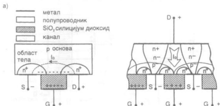
Слика 4.22. – Приказ а) планарне и б) вертикалне структуре MOSFET-а у укљученом стању
