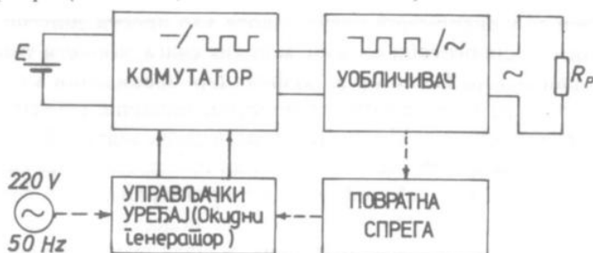
Слика 9.2. – Општа блок-шема инвертора
