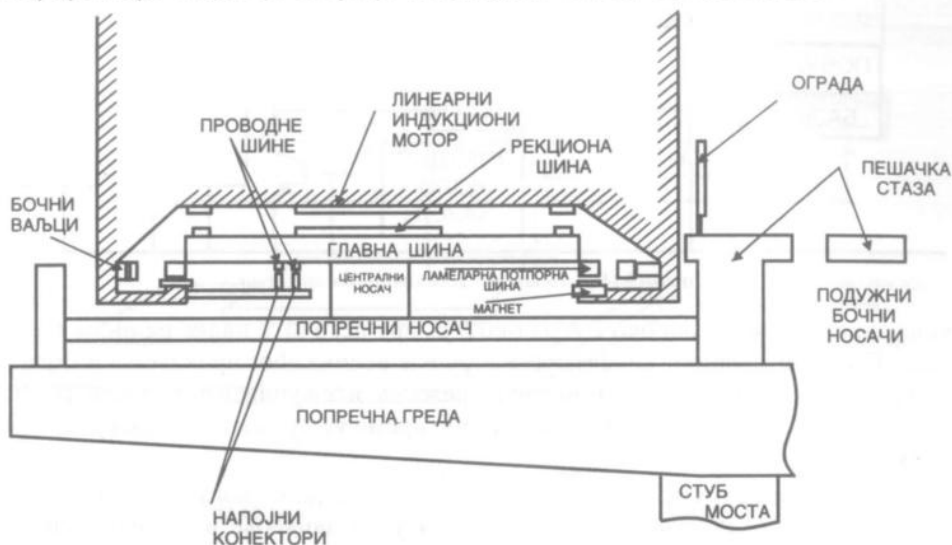
Слика 13.10. – Појречни пресек ђружног сисџема лавиџационе железнице Маџлев
