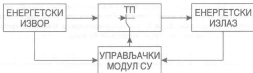
Слика 6.1. – Општа блок-шема једног канала система управљања (SU) тиристорским претварачима (TP)
