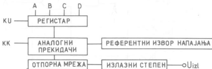
Слика 2.10 – Комплетна блок-шема D/A конвертора
