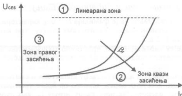
Слика 4.12. – Промене напона засићења између колектора и емитора U_{CEs} у функцији колекторске струје I_C за различите вредности струјног појачања \beta_f
