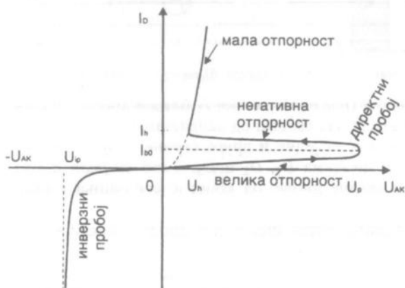
Слика 4.27. – Струјно-напонска карактеристика pnpn диоде
