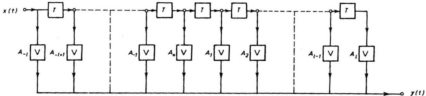
Signal uzet sa svakog izvoda prolazi kroz njemu odgovarajući pojačavač. Pojačanja pojačavača  $A_{-l}, A_{-l+1}, \dots, A_{-1}, A_0, A_1, A_2, \dots, A_l$  mogu da se podešavaju i po svom iznosu i po znaku (pojačanje može biti manje od 1). Izlazni signali iz svih pojačavača se sabiraju i tako daju rezultantni izlazni signal.
