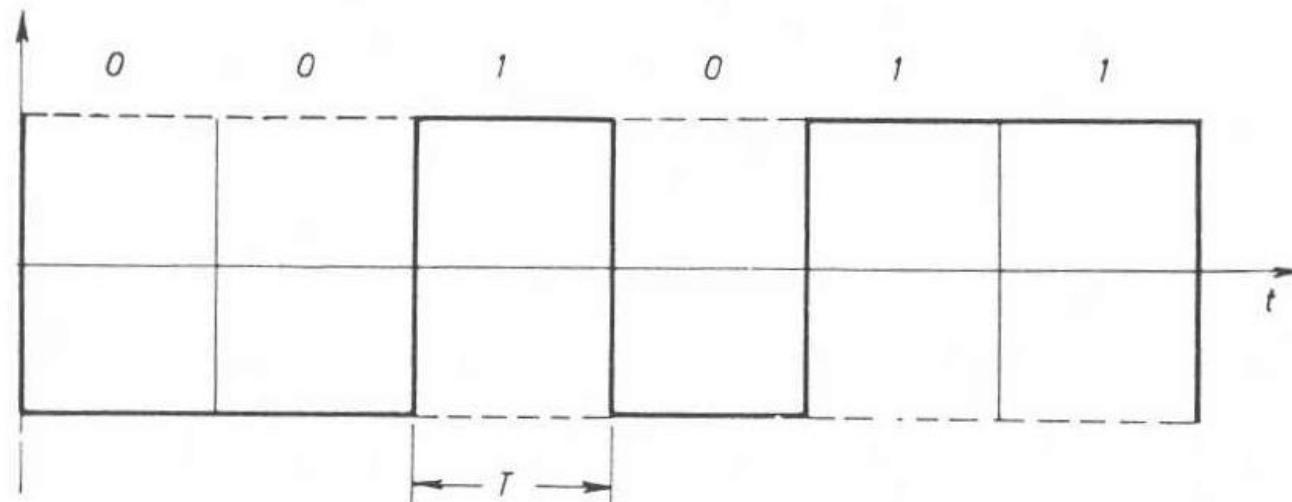
Ako bi se ovakav signal doveo na ulaz osciloskopa čija je vremenska baza podešena trajanju jednog signalizacionog intervala  $T$ , onda bi se na njegovom ekranu dobio dijagram kao na slici. To su dvije deblje izvučene horizontalne linije nastale preklapanjem signala iz svih signalizacionih intervala.
