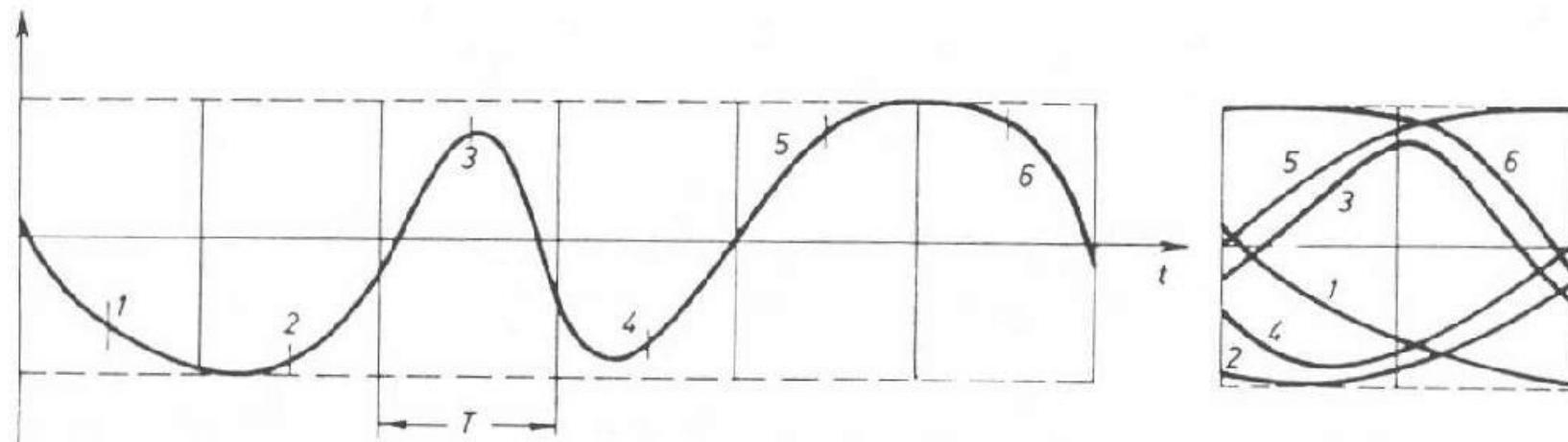
Ovi dijelovi signala iz pojedinih signalizacionih intervala koji su preklopljeni jedan preko drugog daju dijagram oka. Naravno, ako se uzme dugačka povorka impulsa, mnoge linije ce se ispreplesti i obrazovaće se zadebljani tragovi. Oni su prikazani kao osjenčene površine na slici.
