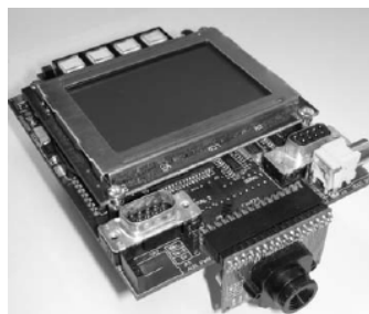
Tipičan ugneždeni sistem za upravljanje robotom.
