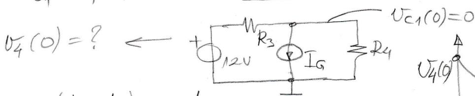
$$V_4(0) \cdot \left( \frac{1}{R_3} + \frac{1}{R_4} \right) - 12 \cdot \frac{1}{R_3} = -I_G$$
