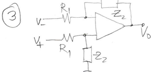
$$V_o = -V_- \cdot \frac{Z_2}{R_1} + \frac{Z_2}{R_1 + Z_2} \cdot \left(1 + \frac{Z_2}{R_1}\right) V_+$$
